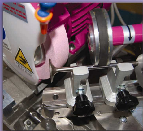
Lavorazione del fungo valvola Processing of the valve head
