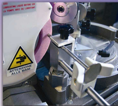
Rettifica del piede valvola Valve end refacing
